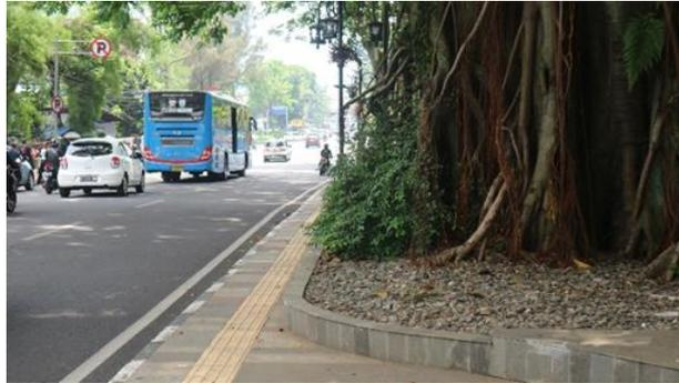
**Gambar 11. Jalur khusus tunanetra yang langsung berbatasan dengan jalan**
