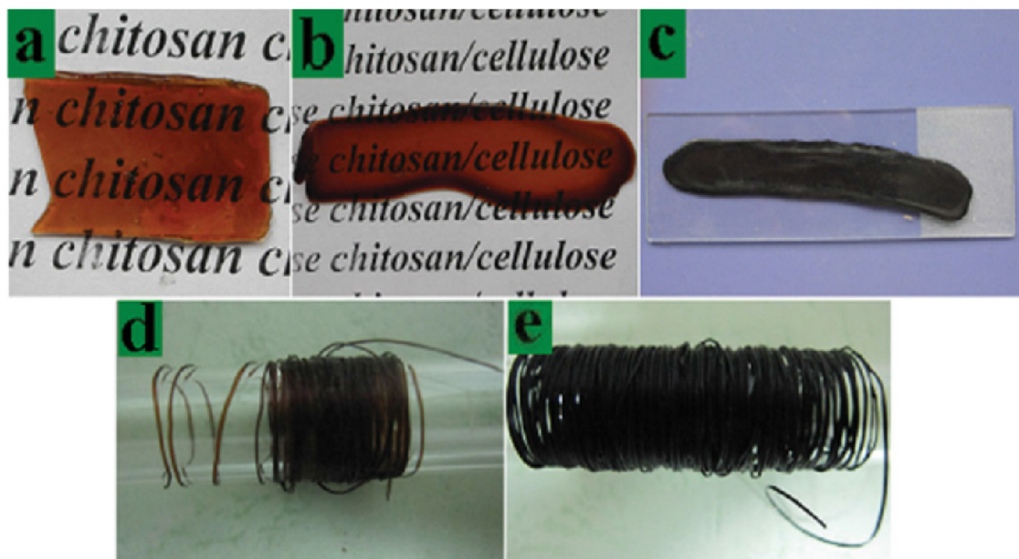
Fig. 5. Image of regenerated (a) chitosan gel, (b) chitosan-cellulose membrane, (c) chitosan-cellulose-multi wall CNT membrane, (d) chitosan-cellulose fibers, (e) chitosan-cellulose-multi wall CNT fibers.
